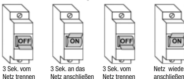
Der SELVE-Elektronik-Funk-Antrieb quittiert die Netztrennung durch eine kurze Fahrt.
